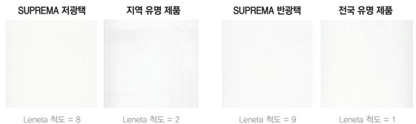
흐름과 고르기 테스트 방법 : 특수 날을 이용해 페인트를 흑색 및 백색 도표에 칠하였습니다. 도표는 24시간 동안 수평 상태에서 건조된 후 마무리의 매끄러움을 확인하기 위해 1= 불량(매끄럽지 않음)에서 10 = 탁월(완전히 매끄러움)까지의 등급이 나타나는 표준 Leneta 척도와 비교 검토되었습니다.
